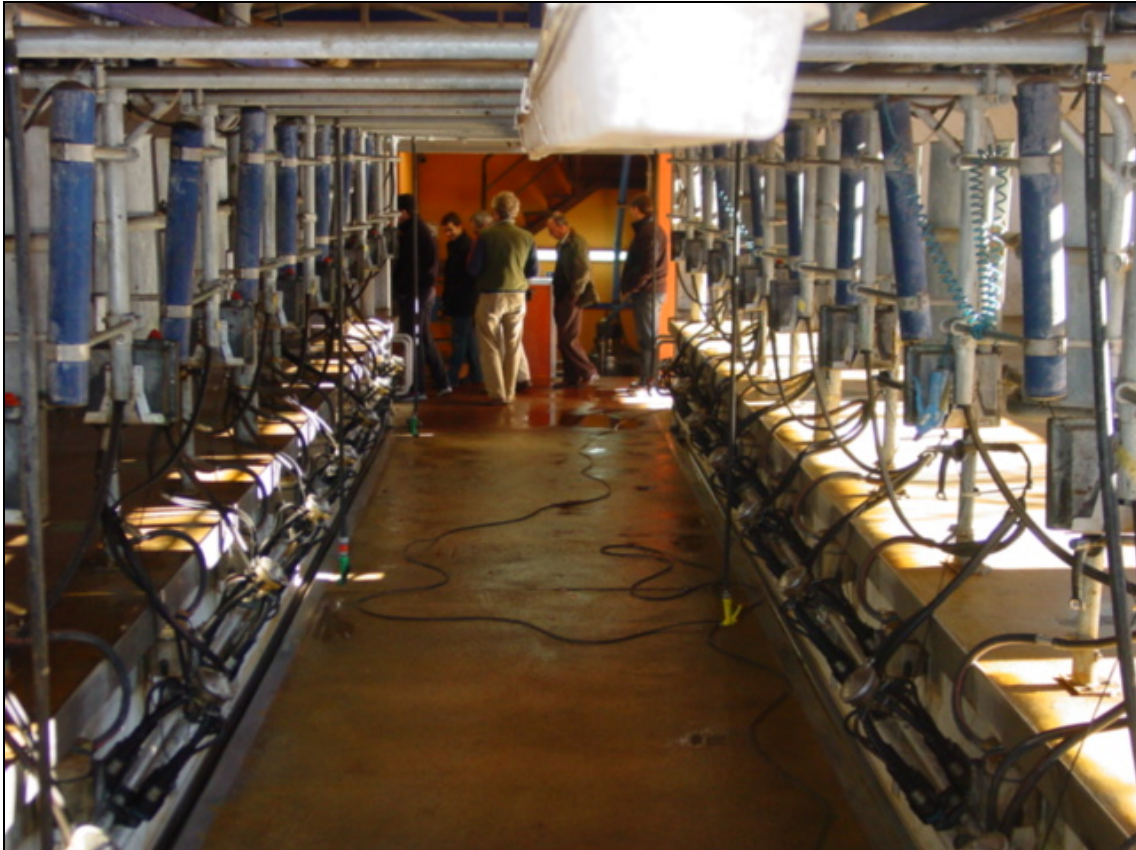
Sala de munyir 2x10, paral·lel, sortida ràpida. Retiradors automàtics de mugroneres, línia baixa.
