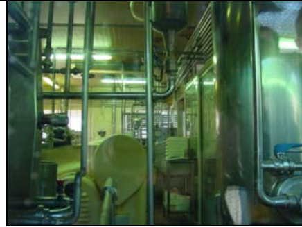
Autoclau de pasteurització per als iogurts (en primer terme) i autoclau d'esterilització per als postres (al fons de la imatge)
