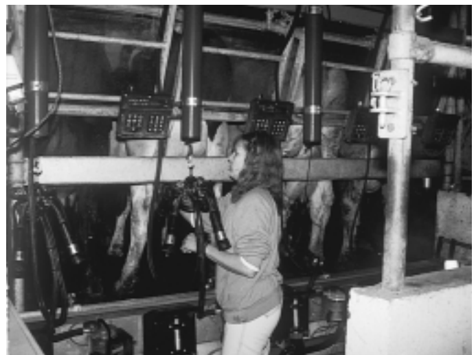
Fig. 15: Dans la salle de traite Side by Side, l'observation du pis n'est pas idéale. Par contre, les déplacements sont très courts.
